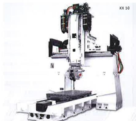
Les KX Large sont équipées d'une électrobroche puissante à grande vitesse (20.000 tr/min pour les KX 50, 18.000 tr/min pour les KX 100 et KX 200). Cette configuration associée à la synchronisation avec la capacité des paramètres dynamiques de la machine permet des paramètres de coupe à grande vitesse, y compris pour des composants aux formes complexes avec des pièces à poches profondes.
